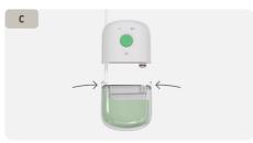
Ta bort behållaren genom att trycka på fjäderknapparna på båda sidor och dra. Enklast är om den fjäderknapp som är räfflad trycks ner och vinklas bort från själva pumpen. Byt till en ny behållare, genom att trycka behållaren på plats tills ett klickljud hörs på båda sidor och den låses på plats.
