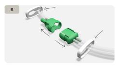
Skjut fram slangklämmorna så att de hamnar nära de gröna kopplingarna och tryck båda klämmorna över slangen för att säkerställa att inget vätskeläckage förekommer vid bortkoppling. Koppla loss slangen från behållaren och slangen från förbandet genom att klämma på kopplingen från båda sidor och dra isär den.
